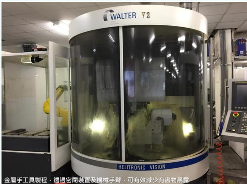
金屬手工工具製程，透過密閉裝置及機械手臂，可有效減少有害物暴露
